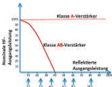
Bild 4: Verhalten von Verstärkern der Klasse A und Klasse AB bei Fehlanpassung
