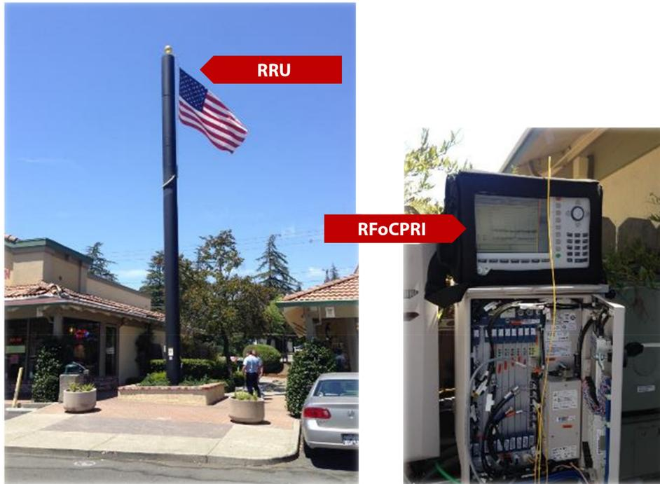
Abbildung 26: Kleinzelle und CellAdvisor mit RFoCPRI
