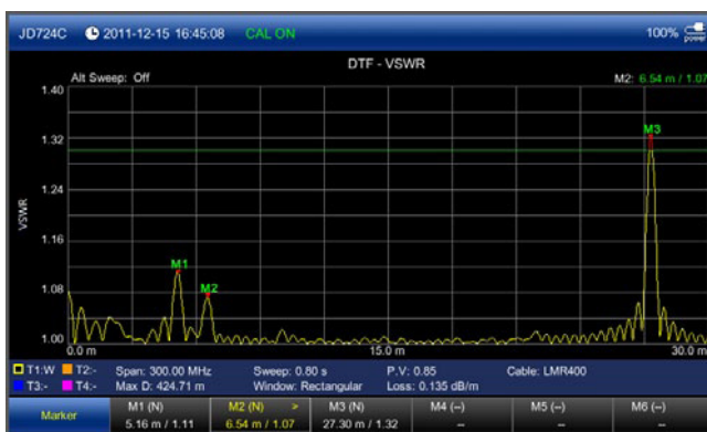
Ermittlung der DTF-Fehlerentfernung: VSWR-Modus
