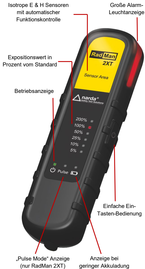
Abb. 1. Vorderansicht mit Bedien- und Anzeigeelementen
