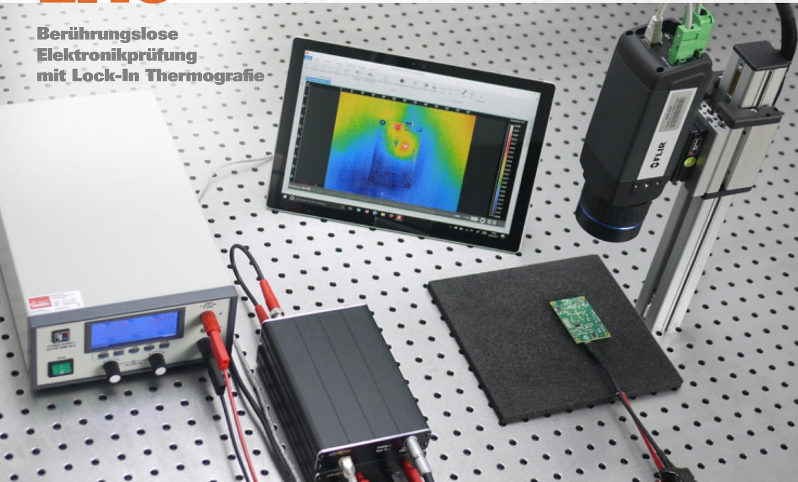
Fehlerhafte Halbleiterbauteile oder Leiterplatten zeigen meist Anomalien im thermischen Verhalten, verursacht durch lokale Leistungsverluste. Diese Unregelmäßigkeiten lassen sich durch Verwendung der Infrarotthermografie sichtbar machen und für Fehleranalyse zielgerichtet einsetzen.
