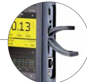
Schnittstellenfach: - USB-C - RP-02 (optisch) - µSD (Speicherkarte) - Ethernet
