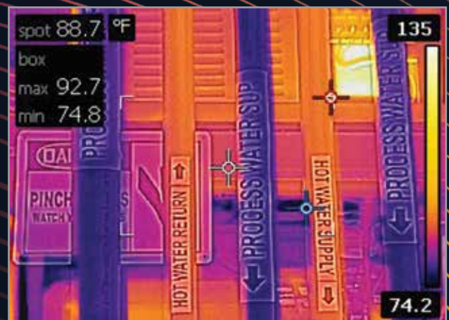
MIT DER PATENTIERTEN FLIR MSX® KÖNNEN SIE KENNZEICHNUNGEN UND ETIKETTEN ZUSAMMEN MIT ALLEN WICHTIGEN MESSDATEN DEUTLICH ERKENNEN UND ABLESEN
