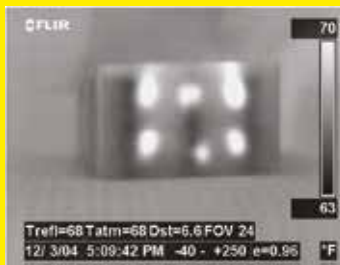
Abbildung 3. Qualitätsprüfung von Kartonversiegelungen mittels Machine-Vision-Technik
