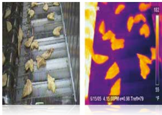
Abbildung 6. Eine Infrarot-Temperaturmessung und ein Wärmebild helfen bei der Lokalisierung nicht durchgegartener Hähnchenteile und sorgen dafür, dass die Produktionslinie angehalten wird, so dass Teile außerhalb der zulässigen Toleranzen entfernt werden können.
