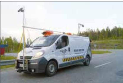
*Dieser besondere Aufbau für die Überprüfung von Brücken verfügt über eine FLIR Wärmebildkamera mit einem  $90^{\circ}$ -Weitwinkelobjektiv.*
