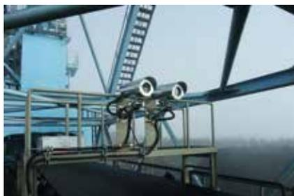
FLIR Wärmebildkameras, die in Schutzgehäusen über Kohlenförderbändern montiert sind.
