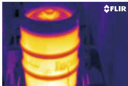
*Denn ein Fass mit Lauge ist wärmer als ein Fass mit Bier. Mit einer Wärmebildkamera lassen sich falsch befüllte Fässer problemlos erkennen, indem die Temperatur gemessen wird.*
