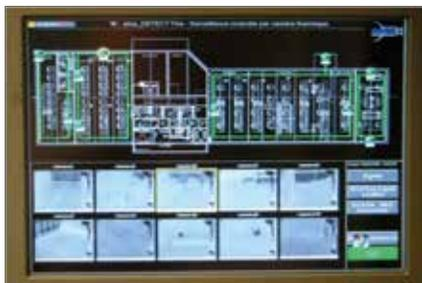
Die Touchscreen-Schnittstelle zeigt den Grundriss und Live-Wärmebild-Videoaufnahmen aller Wärmebildkameras.
