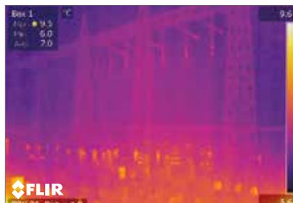
Vier Wärmebildkameras überwachen kritische Komponenten innerhalb der Trafostation. Sobald an irgendeiner Stelle im Sichtfeld der Kamera die Temperatur einen vorab festgelegten Schwellwert überschreitet, wird ein Alarm abgesetzt.
