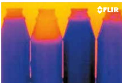
Dieses Wärmebild zeigt automatisch abgefüllte Flaschen. Unzureichend oder übermäßig befüllte Flaschen können aussortiert werden.
