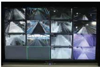
Die Aufzeichnungen und Temperaturwerte der sieben FLIR Wärmebildkameras werden an die speicherprogrammierbare Steuerung und den Kontrollraum gesendet.
