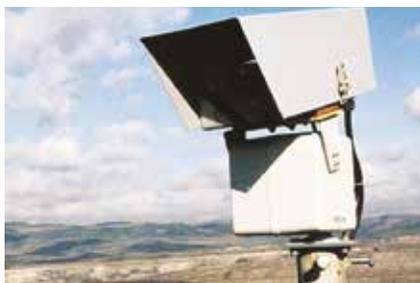
*Die auf einem Mast über der Bergwerksgesellschaft Nástup montierte Wärmebildkamera von FLIR Systems*
