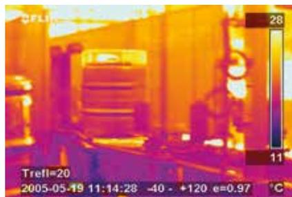
*Wärmebild eines mit Bier gefüllten Fasses*
