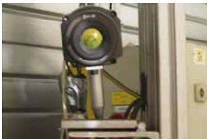
Diese FLIR Wärmebildkamera wird zur Überprüfung der Klimaanlage eingesetzt.
