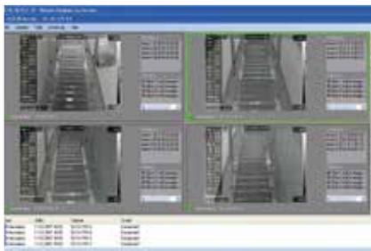
Dieser Screenshot der FLIR Software zeigt Bildmaterial der vier Wärmebildkameras von FLIR, die alle acht Förderbänder überwachen.
