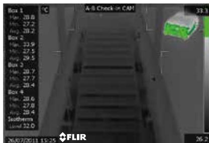
Koffer lösen keinen Alarm aus, selbst wenn der Temperaturschwellwert erreicht ist. Der relevante Bereich (ROI), in dem diese Temperatur erreicht wird, ist zu klein.
