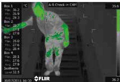
Wenn ein relevanter Bereich (ROI) den Schwellwert erreicht, wird ein Alarm abgesetzt.
