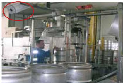
*Die Wärmebildkamera (oben links im Bild) überprüft jedes vorbeigleitende Fass.*
