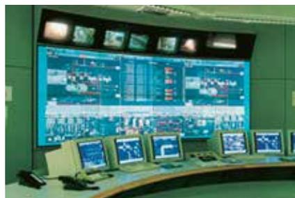
Der Überwachungsraum eines Abfallbunkers. Wenn die Wärmebildkamera eine heiße Stelle entdeckt, wird ein Alarm ausgelöst.
